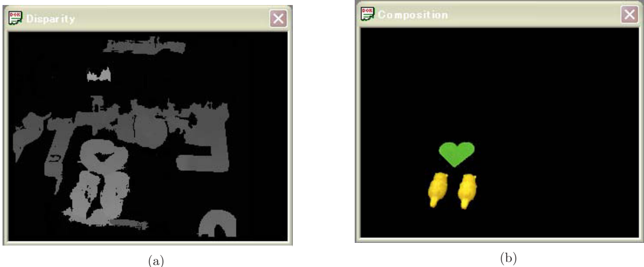
図 5 (a) ステレオカメラから得られる距離画像, (b) 閾値処理を行った後に物体が抽出された様子
