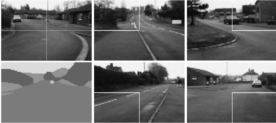
図3 左上の画像は入力画像、右の四つの画像は四つの各領域について検索された類似シーン画像、左下は大域レベルの特徴のみを用いて推定したカテゴリーの分布 Fig. 3 Upper left: Input image, Right four images: Collected similar images, Lower left: Inference of the category distribution using the global features.
